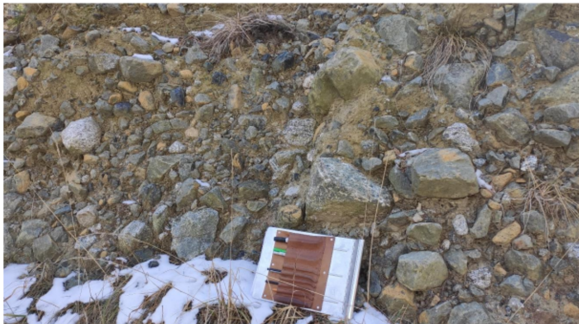
Figura 5 - Dettaglio della matrice decisamente secondaria < 30% del deposito, costituita da limo argilloso di composizione calcarea sovente cementato (reagisce all'HCl titolato all' 8%).
